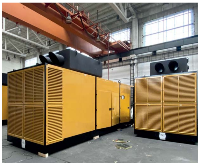
Protihlukové, protiklimatické kapoty dieselgenerátorů CAT.
