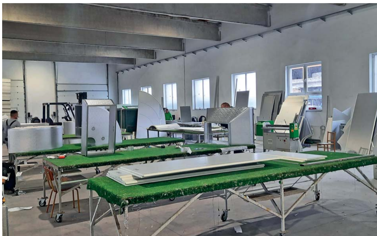
Nové zázemie v Ružomberku umožňuje zvýšiť kapacitu výroby PIR potrubia až na 350–400 m 2 denne.
